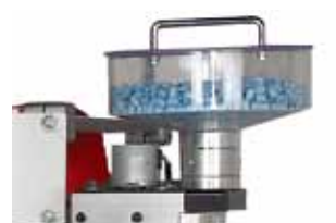
自動送管裝置 Auto bobbin doffing system
