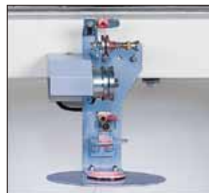
可設定漸減式 電磁張力 Electro-magnetic tension
